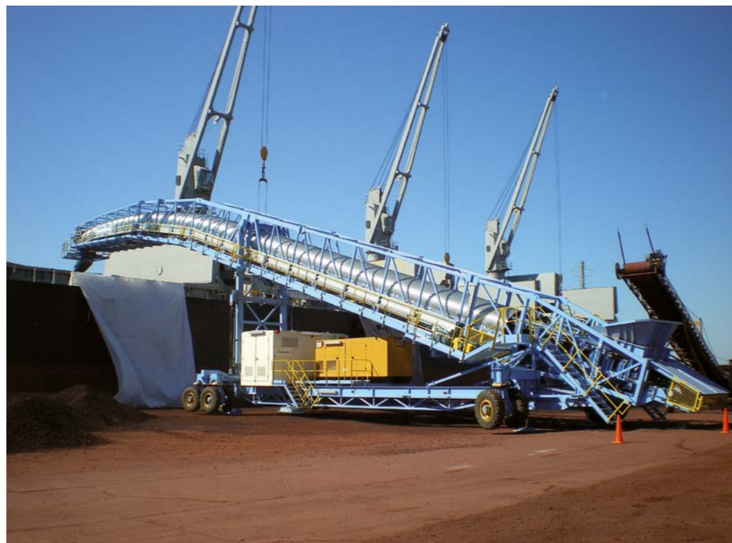
2 Cargador de barcos para mineral de hierro autopropulsado montado sobre neumáticos, capacidad 2.000 t/h, Puerto San Nicolás ( Argentina). Iron ore self-propelled rubber tyre mounted ship loader, capacity 2.000 tph, San Nicolas Port (Argentina). Schiffsbelaeder für Eisenerz auf Radfahrwerken, Leistung 2.000 t/h, Hafen San Nicolas (Argentinien).
