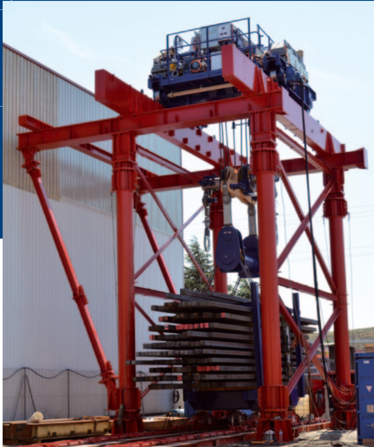
1 Carro SFP (Single Failure Proof) para manejo de combustible nuclear en Central Nuclear de Tihange 2, capacidad 105 t, luz 4 m, Huy (Bélgica).
